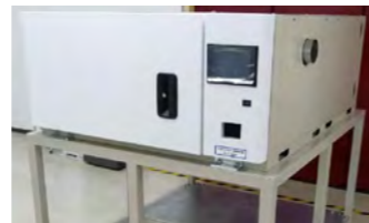
バーンイン装置におけるチャンパー性能の研究 (小型チャンパー)
